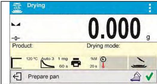
El programa le pide que prepare un platillo de pesaje. Se muestra un pictograma respectivo sobre el estado de la cámara de secado.
