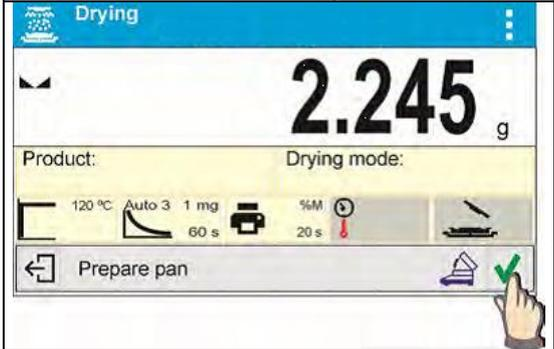
Presione la tecla
