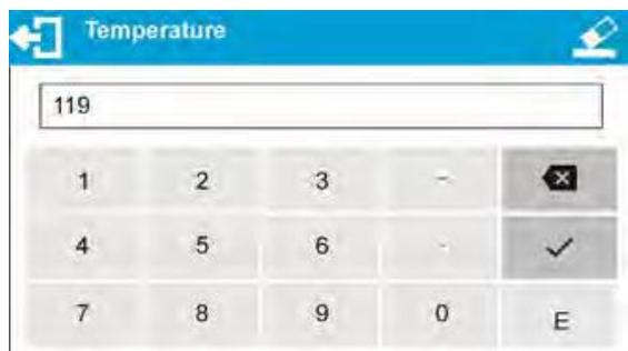
El proceso de mantenimiento de la temperatura durará 8 minutos (de manera similar a la calibración de temperatura). Después de este tiempo, se mostrará una ventana en la que ingresará la temperatura que se lee en el kit de calibración montado en la cámara de secado y presione el botón para confirmar.
