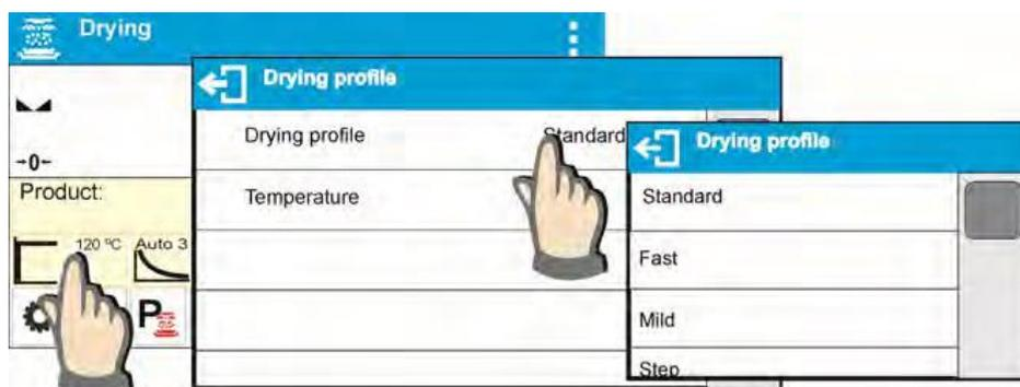
Ingrese la configuración de los parámetros de secado y seleccione el tipo de modo. Luego de los campos de selección, se muestran los parámetros del perfil de configuración. Los parámetros dependen del modo seleccionado.
